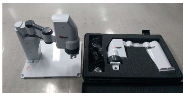
図2 アカデミック・スカラロボット (左：組立状態，右：収納状態)
