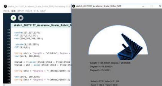
図4 2リンクマニピュレータ運動学シミュレータ (Processing 言語により実習で作成したもの)
