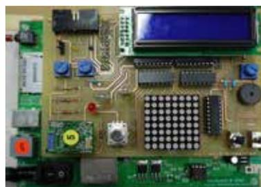
図 1 組立て基板(上)と制御ボード(下)
