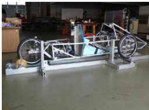
図 8 完成したデータ収集装置
