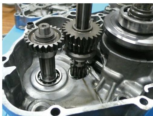
図4 不要ギアを取り外したエンジン内部
