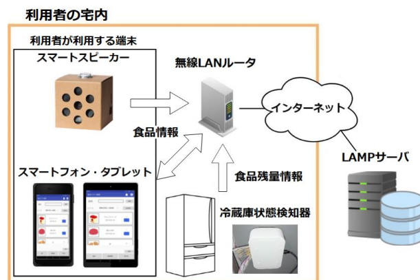
図1 システム概要図 Fig.1 System overview
