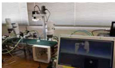
図3 自動ライン実習装置内のロボット選別部 (ASR)
