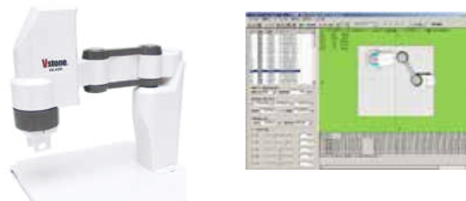
図1 アカデミックスカラロボットとスカラプログラマ ASR はまた、内部構造・通信プロトコルも公開し、Windows/Linux 用サンプルプログラムも配布されており自作プログラム上から簡単に利用可能である。
