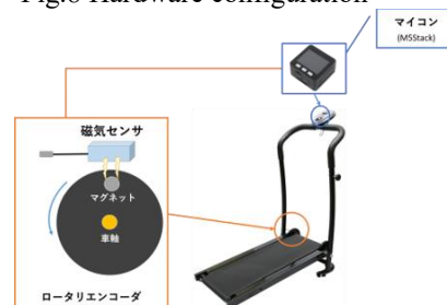
図 9 ロータリエンコーダの機構
