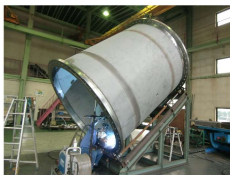
▲電磁流量計の溶接作業
