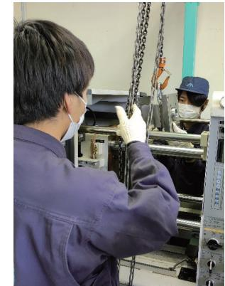
射出成形機（日本製鋼所 J30E-C3）射出成形機に取り付けた金型
