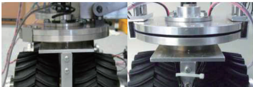
図7.1: 荷重の有無によって変化するクリアランス
