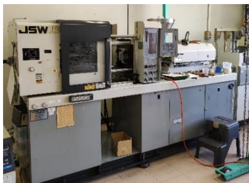
図 1.0 射出成形機（日本製鋼所 J30E-C3）
