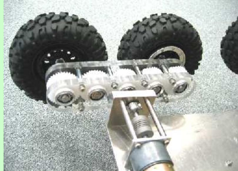
図5 車輪機構
