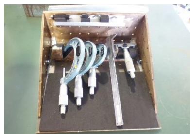
図8 フライス盤用測定器作業台
