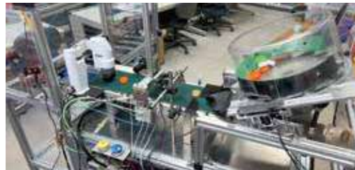
FAライン：自動検査装置
