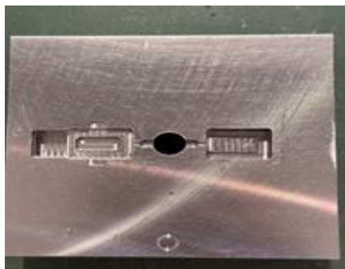
図9 形状加工したキャビティプレート
